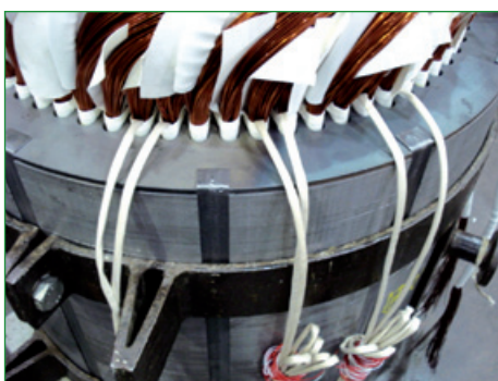
Sondes de température bobinages Figure 51a
