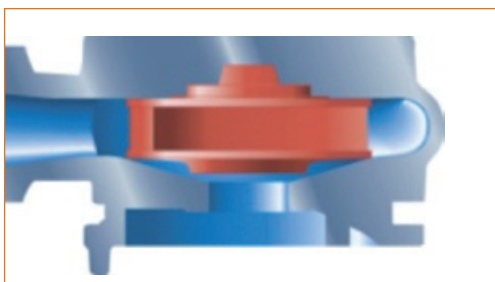
Roue fermée à canaux anti-abrasion
