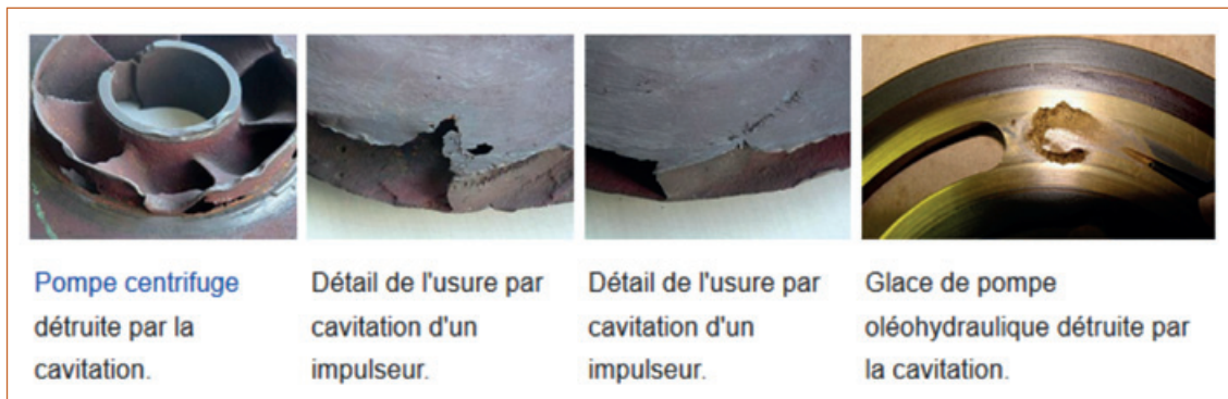
Figure 2 : exemples de dégâts occasionnés par la cavitation sur une pompe
